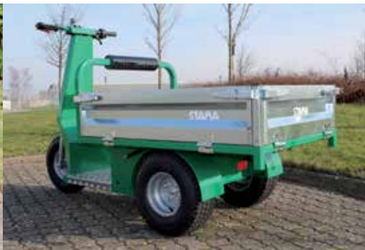
STAMA Micro Truck Smart og handy lille ståtruck med vippelad, der kan komme ind alle steder. Nem på- og afstigning. Kan leveres med blomsterstativ og andet tilbehør
